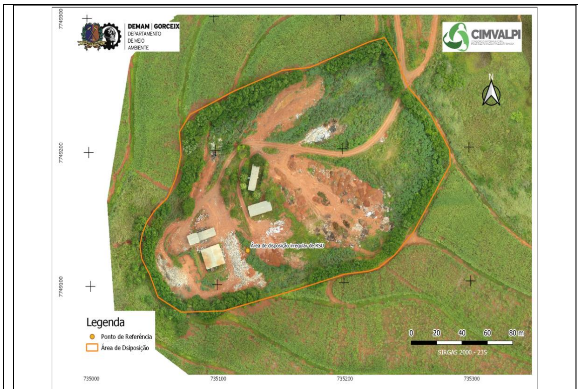
Figura 327– Vista do local de disposição irregular de RSU de Urucânia. Observar grande quantidade de resíduos dispostos em vala e sem cobertura.
