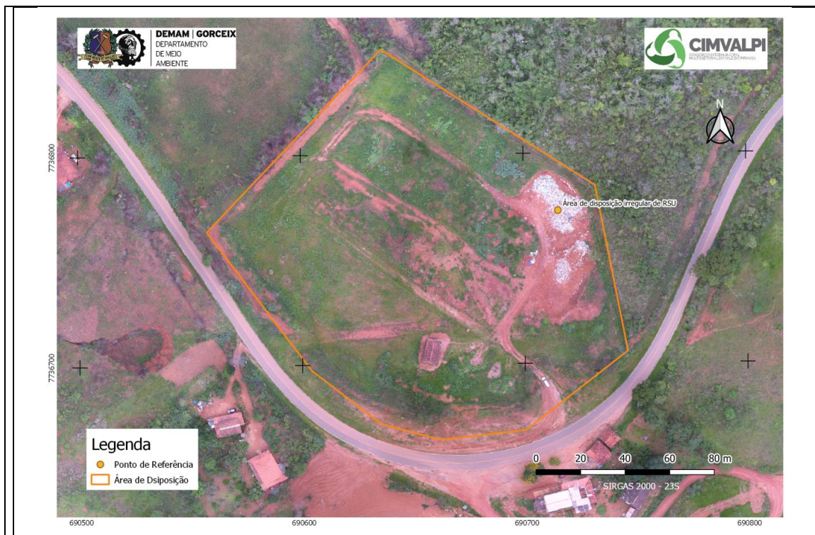
Figura 246–Antigo local de disposição final de RSU de Diogo de Vasconcelos. Observar aterramento com solo e vegetação invasora.
