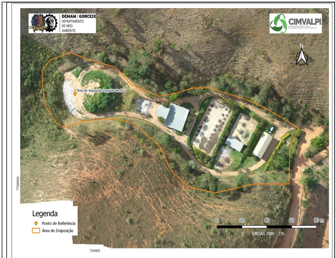
Figura 249– Vala de disposição final dos rejeitos oriundos da UTC, antes da cobertura com terra (frequência inadequada).
