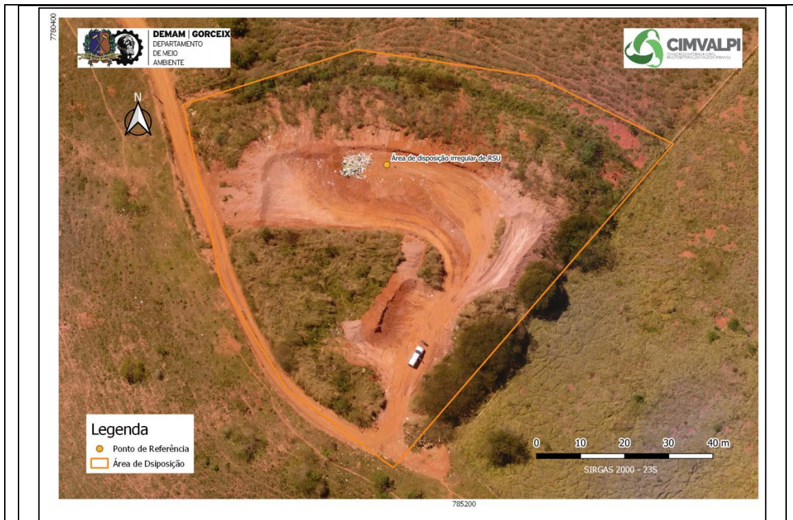
Figura 330– Vista geral do antigo local de disposição de RSU de Vermelho Novo. Observar acúmulo de água, indicando deficiência no sistema de drenagem.
