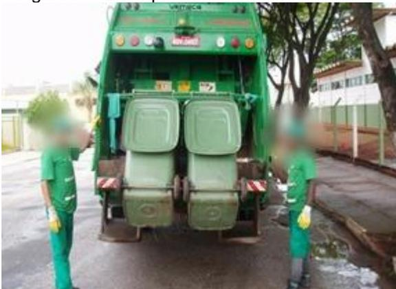
Figura 8 – Exemplo de coleta conteneurizada e automatizada sem necessidade de coletores.
