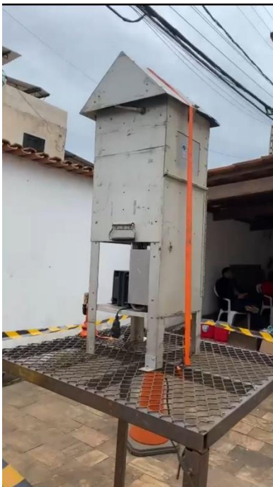
Figura 11: Instrumento de monitoramento de qualidade do ar instalado na comunidade (Hi-Vol).
