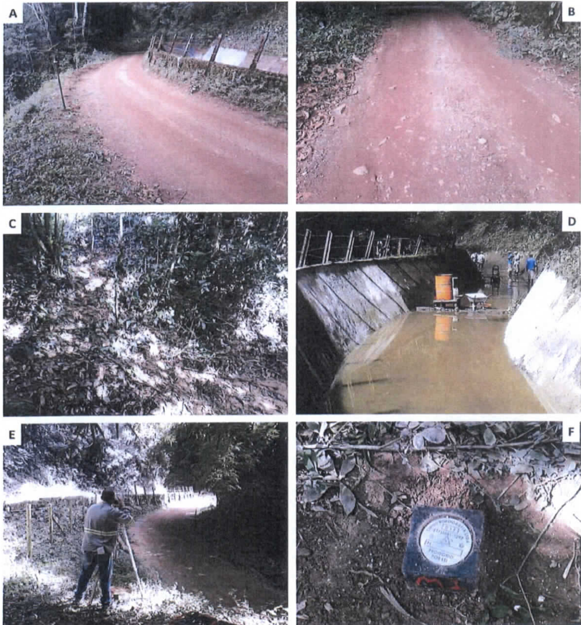
Figura 9: Prancha de fotografias do monitoramento realizado pela equipe Maynard no dia 20/05 pela manhã. A e B: Imagens do acesso mostrando a ausência de trincas; B: Ponto de surgência e carreamento com processo estagnado; D: Equipe de manutenção e vistoria da Maynard; E: Monitoramento topográfico dos marcos; F: Imagem de detalhe mostrando as indicações dos marcos.
